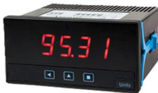
Medida continua de nivel porcentual con 4 salidas relé SPST y salida analógica 4-20 mA. Medidas: 96 x 48 mm. Display escalable a 4 dígitos (9999 a -1999) y 5 niveles de luminosidad. Alimentación universal de 18 a 265 Vac/dc.
