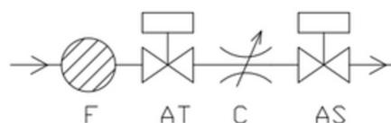
F: Filtro, AT: Válvula N/C, C: Limitador de caudal, AS: Válvula N/A
